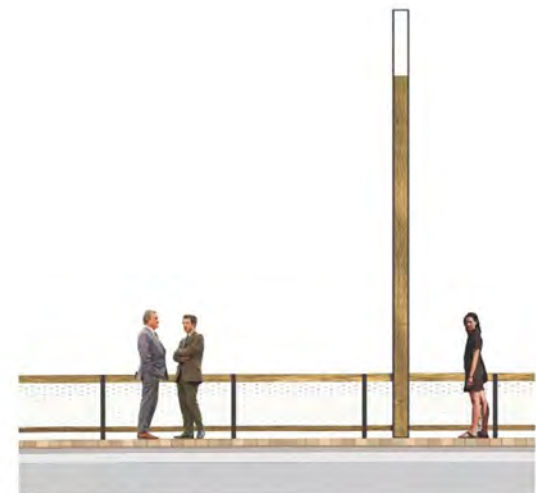
Schnittansicht Römerbrücke Geländer / Mastleuchte M 1:50
