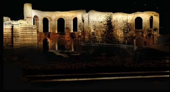
Lichtkonzept Weltkulturerbe-Stätten: Horizontal gleichmäßige Ausleuchtung von oben durch LED
