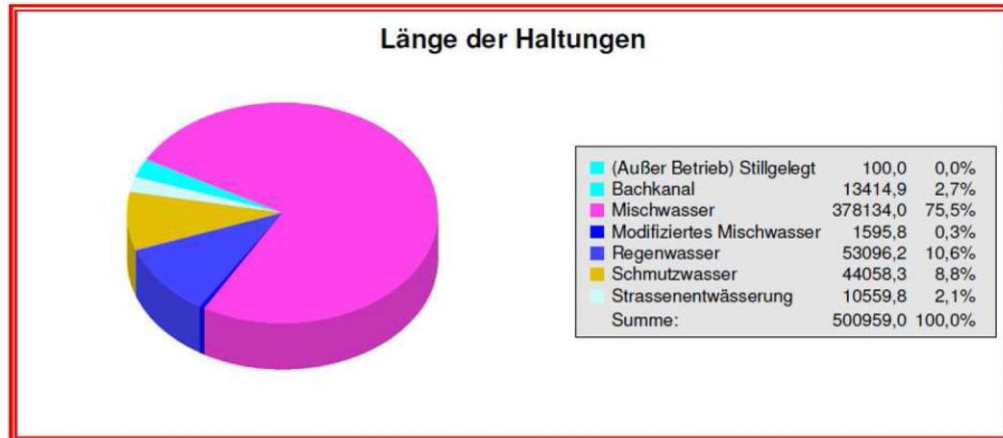
Abb. 32: Kanalnetz im Stadtgebiet von Trier
