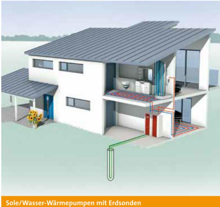
Abbildung 72: Darstellung Sole-Wasser-Wärmepumpe<sup>5</sup>
