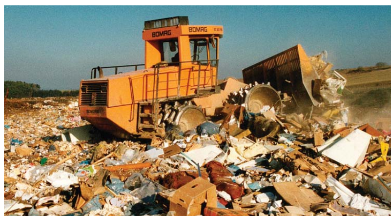
Auf der Deponie. Zur Zerkleinerung und Verdichtung der großen Abfallmengen auf der Deponie kam unter anderem ein Kompaktor zum Einsatz. So wurde das Müllvolumen deutlich reduziert.
