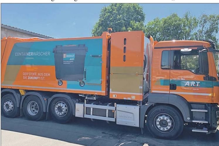
Fahrzeug wird sich dies deutlich verbessern.“ Das Spezialgefährt verfügt über eine Anlage zur Hochdruckreinigung der Container nach der Leerung. Das dabei ablaufende Wasser wird am Fahrzeug aufgefangen, so dass vor Ort keine Rückstände bleiben. „Wir freuen uns, die Entsorgung der Bioabfälle für die Nutzer der Biotüte auch im Sommer angenehmer zu gestalten und die Sauberkeit vor Ort deutlich zu verbessern“, ergänzt Kielholtz.
