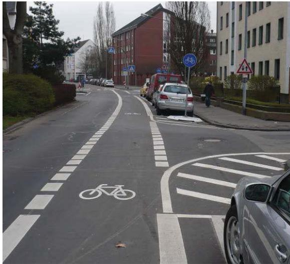
**Abbildung 33: Markierung im Zuge von Radfahrstreifen; hier: Hohenzollernstraße**
